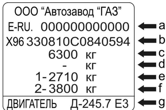
Рис. 1.4. Пример заводской таблички с паспортными данными автомобиля ГАЗ-33081:
