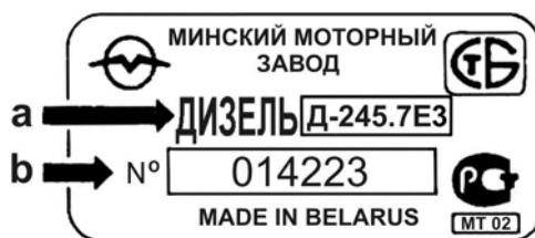
Рис. 1.2. Пример нанесение номера двигателя ММЗ Д-245.7 ЕЗ
