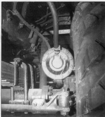
Подвеска передней оси ЗИЛ-157. На левом снимке хорошо виден амортизатор, на правом - элементы пневматической тормозной системы.
