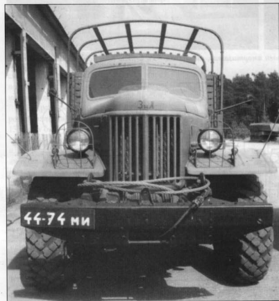
Разные варианты крепления троса лебедки ЗиЛ-157. На верхнем снимке коуш троса просто накрут на передней клязь, на нижнем - несколько метров троса петлями уложены на передние клязьи. И в том, и в другом случае барабан торможет от саморазматывания.
