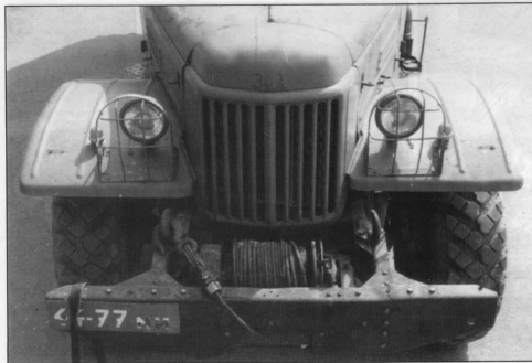
Разные варианты крепления троса лебедки ЗиЛ-157. На верхнем снимке коуш троса просто накрут на передней клязь, на нижнем - несколько метров троса петлями уложены на передние клязьи. И в том, и в другом случае барабан торможет от саморазматывания.
