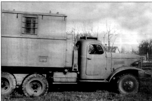
ЗиЛ-151 с «кузовом универсальным нормализованных габаритов» (КУНГ) радиолокационной станции ПВО. Фото 1959 г.
