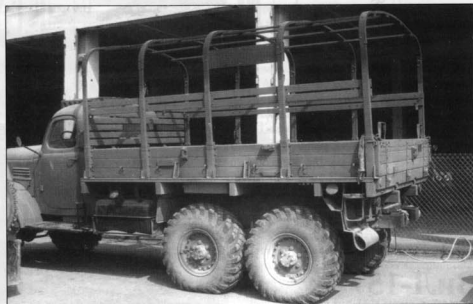
Армейский ЗиЛ-157 с универсальным кузовом и установленными дугами тента.
